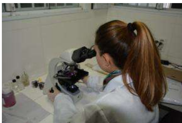
Fotos 3.2.2-1 e 3.2.2-2. Amostra na câmara de Sedgewick-Rafter preparada para análise em microscópio óptico e identificação do zooplâncton em microscópio óptico.
