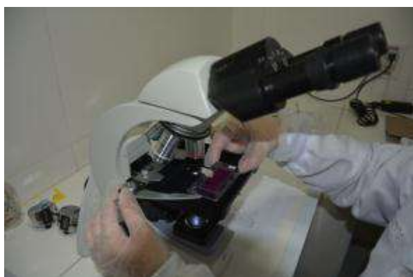
Fotos 3.2.2-1 e 3.2.2-2. Amostra na câmara de Sedgewick-Rafter preparada para análise em microscópio óptico e identificação do zooplâncton em microscópio óptico.
