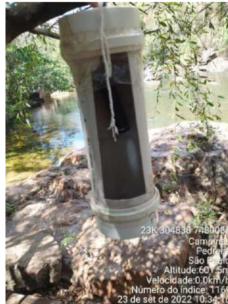
Figura 2: Verificação da armadilha do tipo CDC devidamente instalada. (Data: 23/09/2022)
